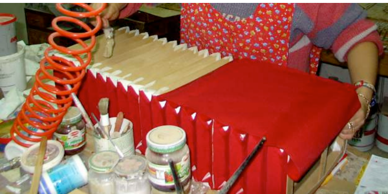
Incollatura del rivestimento di un mantice
